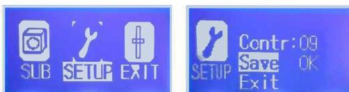
Nello stato del menù principale, ruotare il tasto multifunzione a sinistra e a destra per portare il cursore sulla voce SETUP e premere il tasto multifunzione per entrare nel sottomenù, ed operare in Contr (contrasto schermo) e Save (salva) opzioni. Dopo aver regolato tutti i parametri DSP, spostare il cursore sulla voce Salva, tenerlo premuto per 5 secondi, quindi rilasciarlo,
