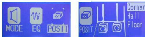
Nello stato del menu principale, ruotare il tasto multifunzione a sinistra e a destra per spostare il cursore sulla voce POSIT (effetto di posizionamento degli altoparlanti) e premere il tasto multifunzione per accedere al sottomenu. Selezionarne uno tra Angolo, Parete, Pavimento, quindi premere il tasto multifunzione per confermare.
