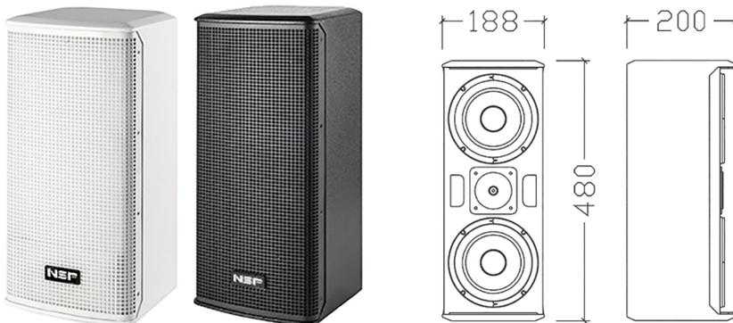
L'impedenza a 16 ohm di questo modello consente di collegare in parallelo fino a 4 diffusori ottenendo un'impedenza totale di 4 ohm
